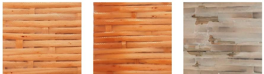
**Bild 5.** WTC-Prüfkörper nach Konditionierung: Im Vergleich zum Normklima-Probekörper (links) zeigt sich bei Wasserlagerung eine Verfärbung am Rand des Körpers (mitte). Durch Bewitterung (rechts) wird die Kunststoffmatrix beschädigt und vergraut. Auch die Weidenfasern weisen dann Farbveränderungen und Schäden auf. © IfWK
